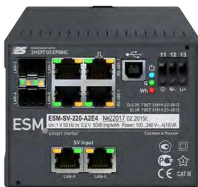
Рис. 1: многофункциональное интеллектуальное устройство ESM
